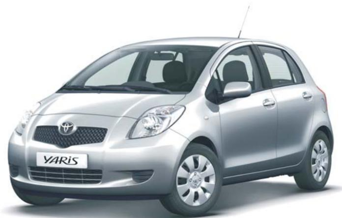
En todas las versiones la caja de cambios de cinco velocidades, la dirección asistida electrónica, el cuadro de instrumentos 3D digital, el volante regulable en altura y la bandeja cubremaletero son de serie.
